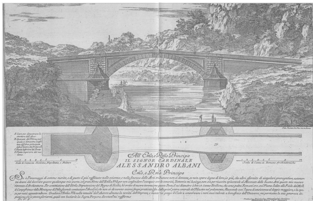
Figura 25. Il ponte di Campofranco secondo il progetto di ricostruzione del “Capitano ingegnere” Michelangelo Blasco del 1742. L’incisione è di Francesco Philothe Du Flos.
