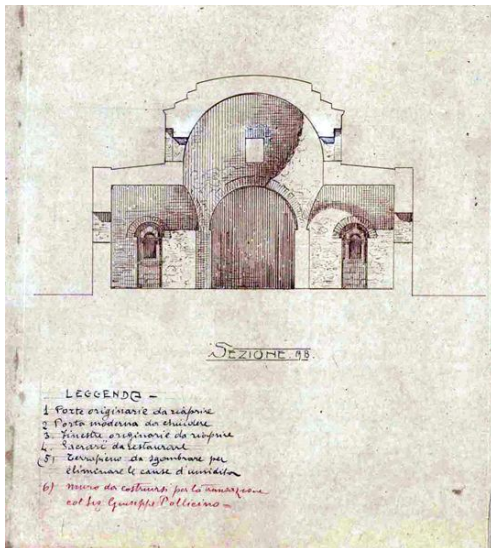
Figura 25. Francesco Valenti, chiesa di Santa Maria dei Cerei (copia eliografica). Tavola di progetto della perizia del 1919 con la sezione AB. La legenda si riferisce alla figura successiva.
